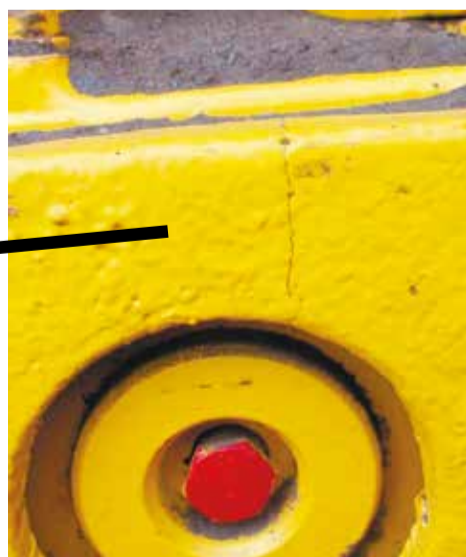
Трещина в крышке натяжного колеса у трубоукладчика ЧЕТРА ТГ503К, эксплуатируемого в ОАО «Михайловский ГОК», появилась уже на 79-м моточасу
