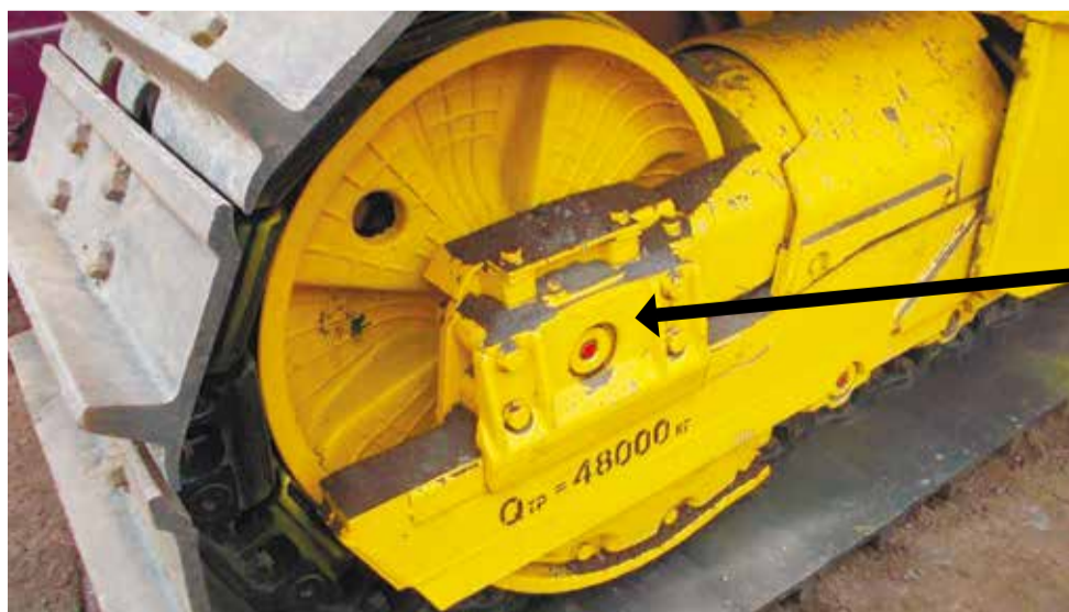
Трещина в крышке натяжного колеса у трубоукладчика ЧЕТРА ТГ503К, эксплуатируемого в ОАО «Михайловский ГОК», появилась уже на 79-м моточасу
